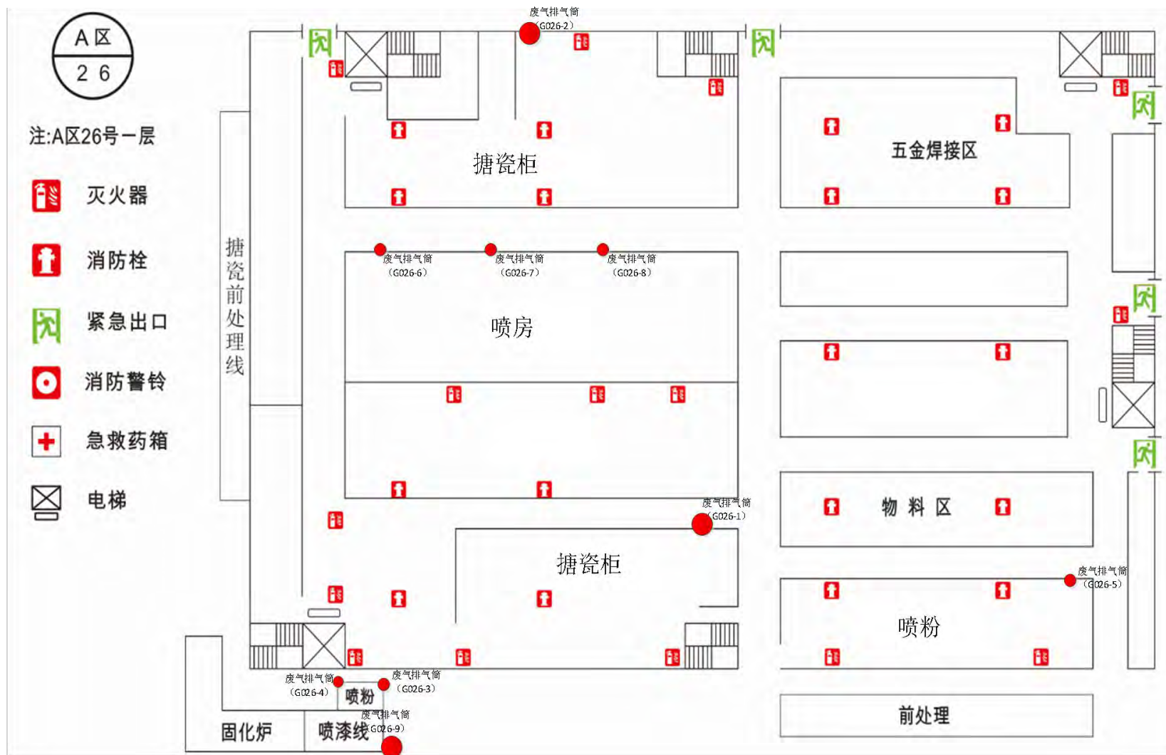
图 2.1-17 A26 (一层) 平面布置图
